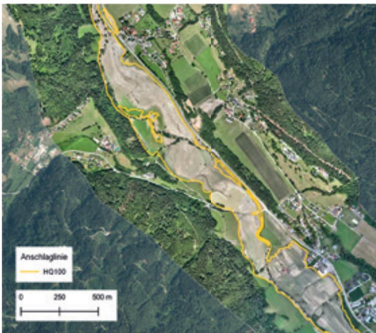
Gute Übereinstimmung der Überflutungsfläche des Afritzer Baches zwischen Köttwein und Winklern bei dem Ereignis im Juni 2022 mit der im Gefahrenzonenplan berechneten 100-jährlichen Anschlaglinie.
